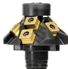
Głowica skrawająca 45° z płytkami 3x3-krawędziowymi umieszczonymi po 9sztuki w dwóch rzędach, Z dedykowaną rolką prowadzącą i płytkami typu K.
