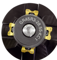
Głowica skrawająca 45° z płytkami 3x3-krawędziowymi umieszczonymi po 9sztuki w dwóch rzędach, Z dedykowaną rolką prowadzącą i płytkami typu K.
